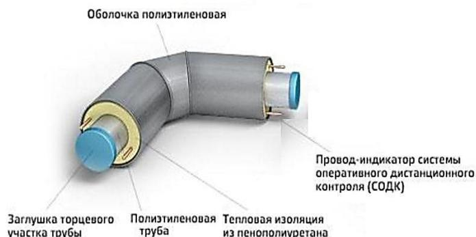
Как и трубы ППУ, отводы покрыты теплоизоляционной оболочкой из пенополиуретана и также могут иметь стандартную или усиленную теплоизоляцию.
