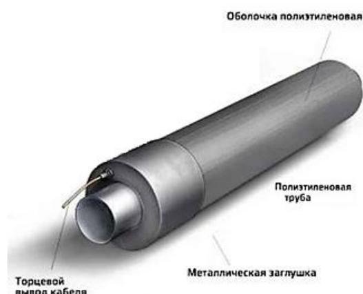
Промежуточный элемент трубопровода с кабелем вывода применяется при монтаже трубопровода, оснащенного системой ОДК, и устанавливаются на участках, требующих подключения к терминалу для дальнейшего контроля состояния ППУ изоляции.
