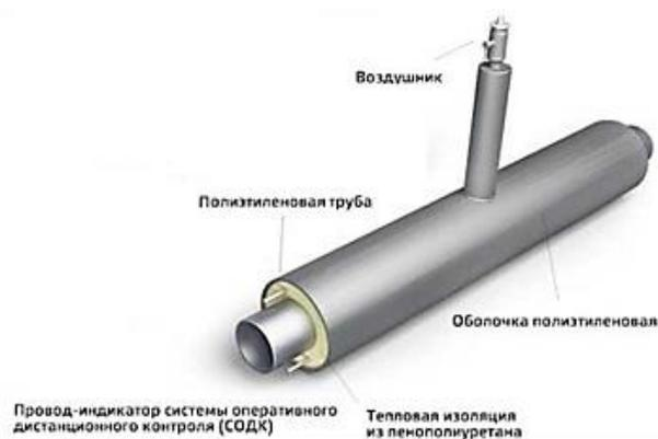
Тройник в ППУ изоляции служит для изменения направления транспортируемой среды относительно основной магистрали трубопровода.
